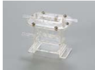
Водяная рубашка. Обычно используется для поддержания постоянной температуры в образце или для изменения температуры образца. При этом необходимо использовать водяной резервуар для подогрева воды.
