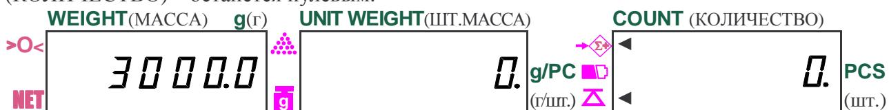
□ Уберите второй груз с платформы (показание на дисплее **WEIGHT** (МАССА) обнулится) и положите следующий взвешиваемый груз на платформу. Указатель нуля >O< выключится, а стабильности  $\Sigma$  - сначала выключится, а затем включится вновь. На дисплее **WEIGHT** (МАССА) высветится показание массы груза (здесь: 5000,0 г).
