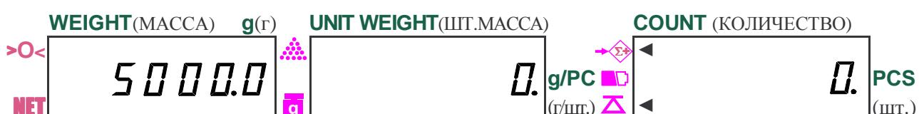
И так далее для всех грузов. В процессе суммирования или при его завершении имеется возможность проверить накопленную сумму. Например, после 3-го взвешивания, когда на дисплее **WEIGHT** (MACCA) высвечивается текущая масса (здесь: 5000,0 г) или груз снят, достаточно нажать клавишу **TOTAL**, и повторятся показания:
