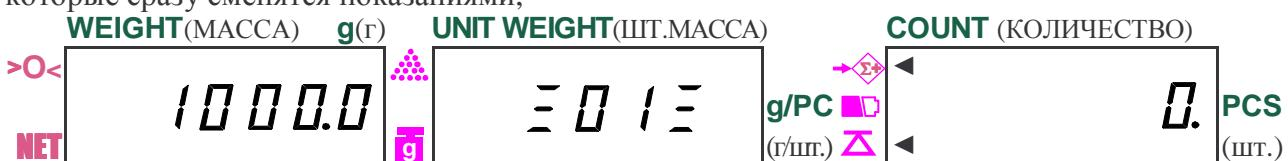
высвечиваемыми в течение ~ 3 сек (указатель суммирования  $\rightarrow \Sigma$  будет включен). Здесь на дисплее UNIT WEIGHT (ШТ.МАССА) высвечивается порядковый номер взвешивания, а именно № 1. Затем показание на дисплее UNIT WEIGHT (ШТ.МАССА) обнулится, а на других дисплеях останутся прежними.
