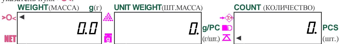
Если взвешиваемый груз имеет слишком малую массу, меньше 10 d, после его взвешивания на дисплее **UNIT WEIGHT** (ШТ.МАССА) включится указатель  $\Delta$ . На процедуре взвешивания это конкретно не сказывается, но в счетном режиме его включение информирует оператора, что дальнейшее измерение штучной массы приведет к слишком большой относительной ошибке в результате счета.
