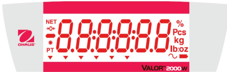
Рис. 3-3. Задний дисплей Valor 2000W-V22PW.
