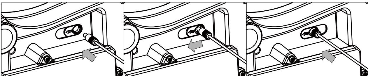
Рис. 2-3. Сдвиньте защитную заслонку по стрелке, чтобы подключить кабель.
