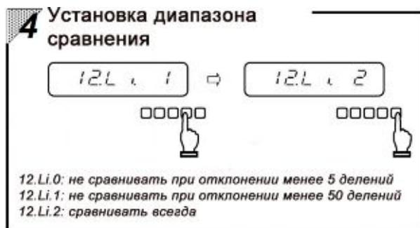
Нажмите кнопку Function для перехода к установке диапазона сравнения. Выберите нужный параметр нажатием кнопки Zero/Tare.
