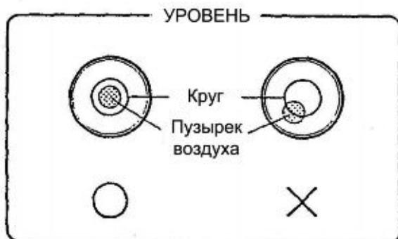
Вращая регулируемые ножки, установите пузырек воздуха в центр синего круга индикатора уровня. Проверьте стабильность положения весов, по очереди надавив на каждый угол платформы.
