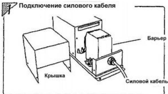
Снимите крышку и подсоедините силовой кабель.
