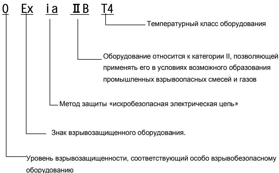
Знак «X», следующий за маркировкой взрывозащиты означает, что замена батарей электропитания весов допускается только вне взрывоопасной зоны.
