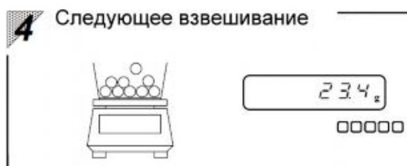
Поместите в тару или на платформу второй образец. На дисплее отобразится только масса второго образца.
