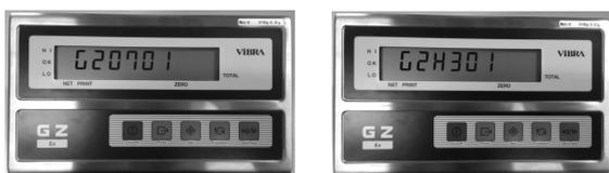
При включении весов на дисплее отображается номер версии программного обеспечения (ПО). Убедитесь, что номер версии ПО соответствует номеру, указанному в описании типа средства измерений.
